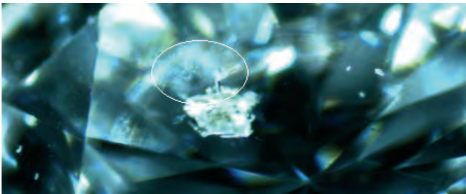
激光钻孔后在进入刻面留下的烧伤痕
